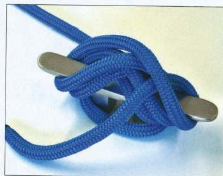
▲ Inutile d'empiler les croisements : un seul huit correctement réalisé suffira.
