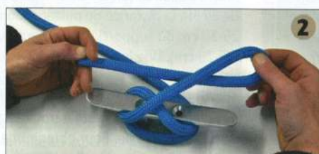
▲ Retournez votre main (droite ici) de manière à former une boucle, l'extrémité de l'amarre passant sous le courant du cordage.
