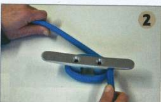
▲ Quand elle est à la bonne longueur, faites un tour mort complet.
