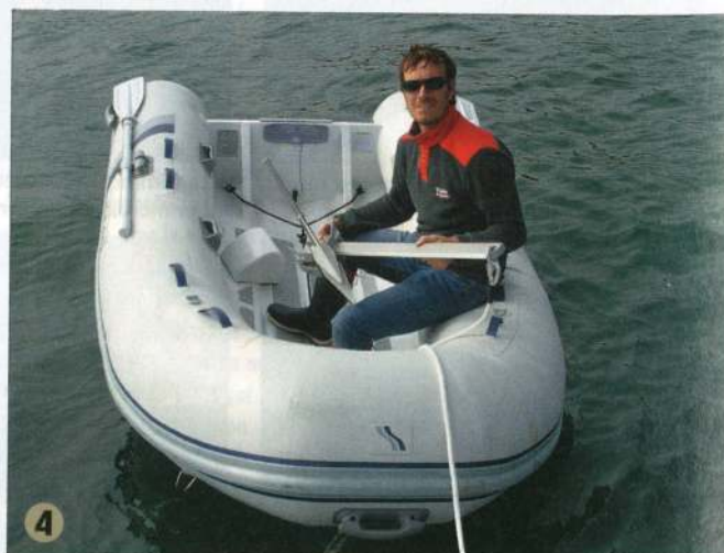
4 ▲ On peut aussi mouiller la seconde ancre avec l'annexe. Il faut y placer la totalité de la chaîne pour éviter que le rappel ne vous empêche d'avancer.
