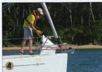
4 ▲ À pic, on relâche peu à peu de la chaîne pour atteindre au minimum trois fois la hauteur d'eau.
