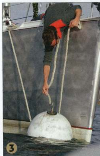
1 ▲ L'équipier indique au barreur la position de la bouée (distance et azimut). Puis il prépare une longue boucle sur l'aussière pour pouvoir la jeter en lasso.
