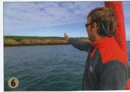
6 ▲ Pour vérifier la tenue du mouillage, on prend systématiquement des relèvements à terre.
