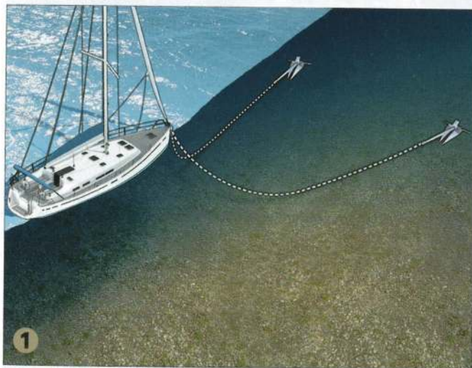
1 ▲ On peut être amené à affourcher lorsque le vent doit tourner ou pour limiter l'évitage. Les efforts sont alors répartis sur les deux ancres.
