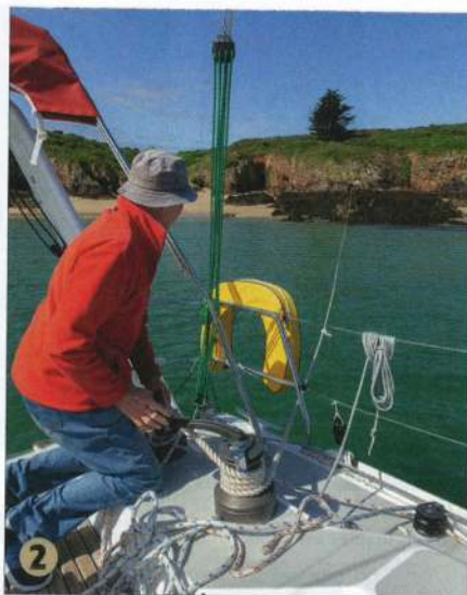
2 ▲ Reprendre le mou de l'aussière avec un winch pour tendre cette dernière est le plus efficace.
