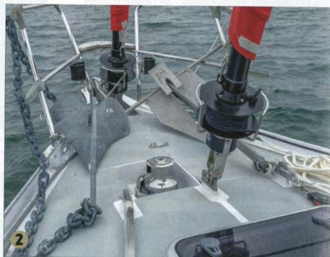
2 ▲ Pour affourcher dans les règles, on prépare les deux mouillages côte à côte, chacun dans son davier.
