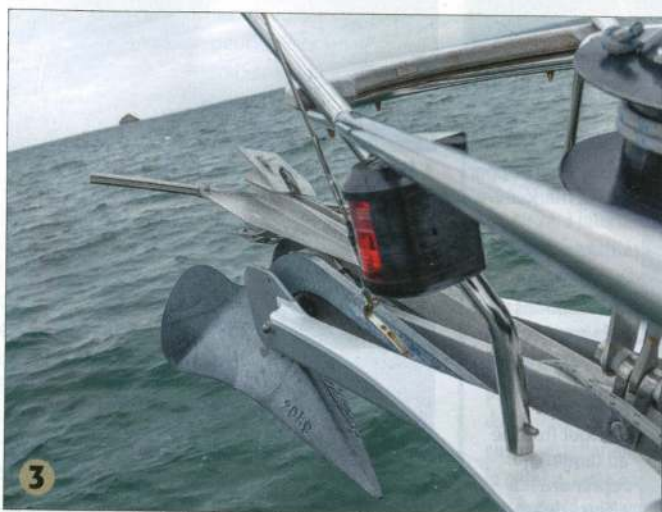
3 ▲ Une fois l'ancre principale mouillée face au vent, on monte au moteur pour positionner la seconde. L'angle entre les deux ne dépassera pas 45°.
