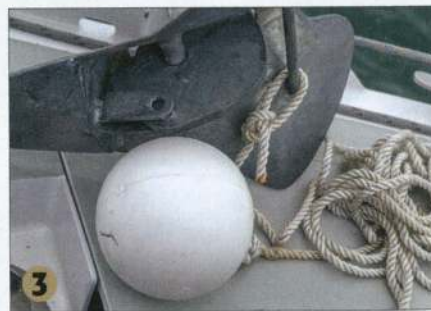
3 ▲ Si l'on décide d'oringuer, il faudra préparer en amont le bout sur le diamant de l'ancre.
