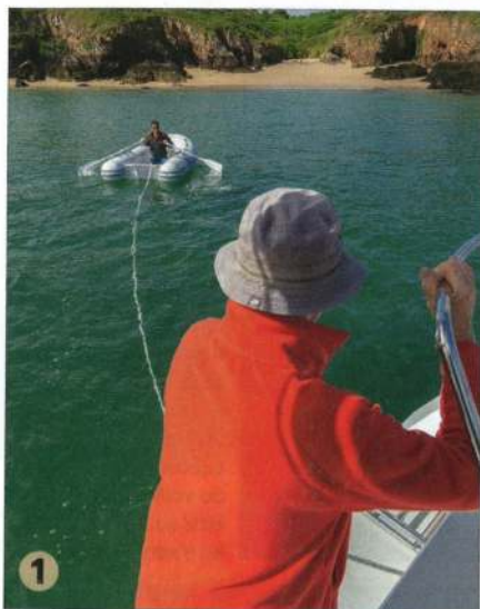
1 ▲ Pour frapper une aussière à terre, on utilisera l'annexe. Prévoir assez de longueur de bout!
