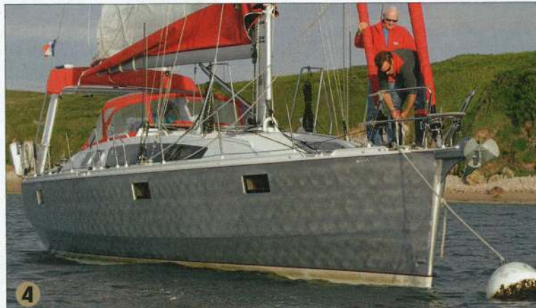
4 ▲ L'idée est de réaliser un long nœud de chaise pour faciliter le décrochage. On donne aussi de la longueur à l'aussière pour éviter que la bouée vienne cogner sur l'étrave.
