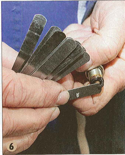
▲ Un jeu de cales d'épaisseur est nécessaire pour vérifier l'écartement des électrodes de la bougie.
