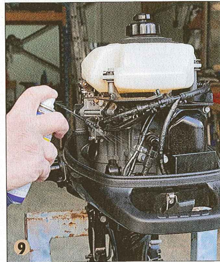
▲ N'hésitez pas à pulvériser un film de lubrifiant sur l'ensemble du moteur pour le protéger.
