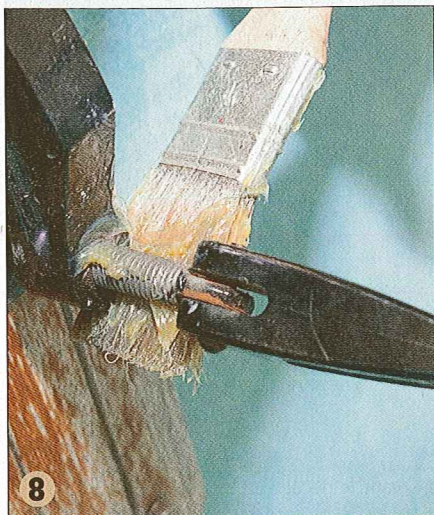
▲ Profitez-en pour graisser tout ce qui peut l'être, des vis de presse à la commande de gaz.
