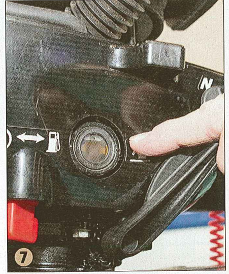
▲ S'il fallait vidanger l'huile, on utiliserait la jauge transparente pour refaire le niveau.
