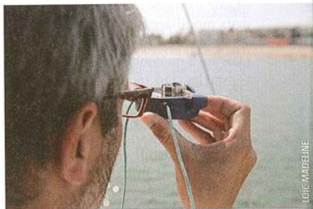
Le compas de relèvement reste l'outil indispensable pour vérifier que le bateau est stabilisé sur son mouillage.
