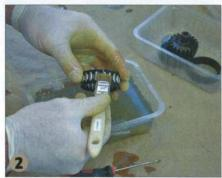
▲ Maël utilise deux bacs : après avoir nettoyé soigneusement une pièce, il la dépose dans un second bac propre. N'oubliez pas de mettre des gants!
