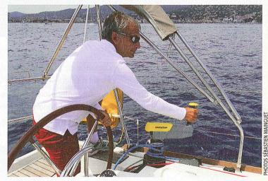
Quand on tourne la manivelle de 180 degrés pour utiliser l'autre vitesse du winch, la rotation s'inverse automatiquement. Difficile de faire plus simple!
