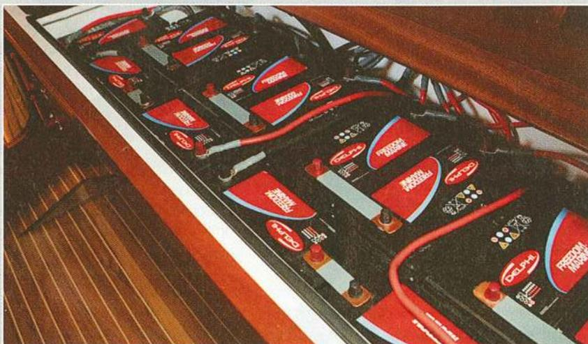
▲ Il faut distinguer les batteries de servitude, destinées à alimenter les équipements du bord, et celles spécifiquement dédiées au moteur et à son démarrage.
