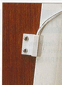
▲ A gauche, le capteur d'eau placé au plus bas des fonds, à droite le témoin d'intrusion.
