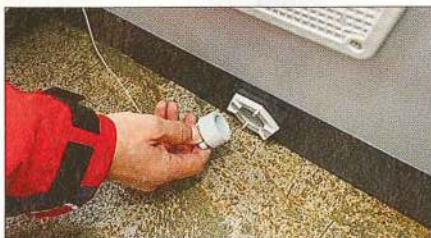
▲ Le constructeur a opté pour un bouchon avec gârcette pour l'évacuation de l'eau des fonds.
