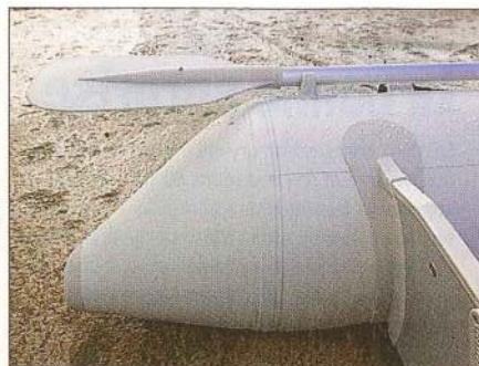
▲ La forme conique des boudins arrière permet d'augmenter la stabilité de l'annexe.
