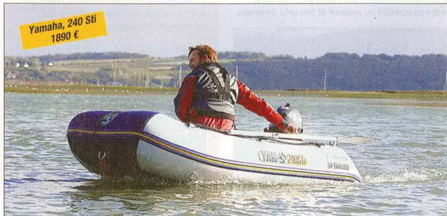
▲ Le modèle avec fond gonflable est plus facile à manier au moteur que celui avec des lattes. Il est parfois nécessaire d'équilibrer avec son poids pour parfaire le virement face au vent.
