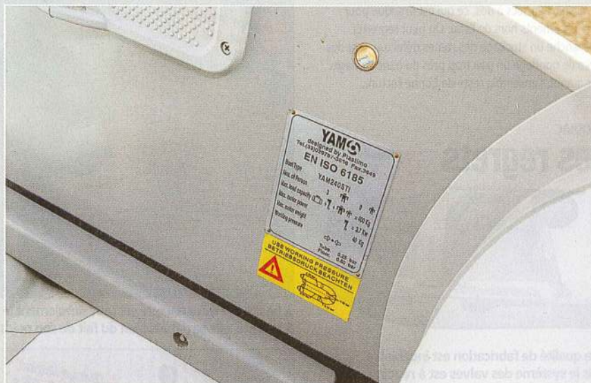
▲ Chaque fabricant stipule clairement grâce à une plaque vissée dans le tableau arrière le nombre de personnes autorisé à bord et la puissance maximale du moteur pouvant être embarquée.
