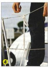
Avant d'aller tourner sur la filière du haut (1), on a fait un tour mort sur celle du bas pour répartir la traction. Ensuite, le mouvement consiste à passer devant le bout, puis derrière la filière (2) avant de replonger dans la boucle (3). Et on peut finir par une ganse de sécurité (4) qui sera vite défaite.
