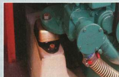
▲ Gare aux signes d'affaissement ou de décollement des silentblochs.
