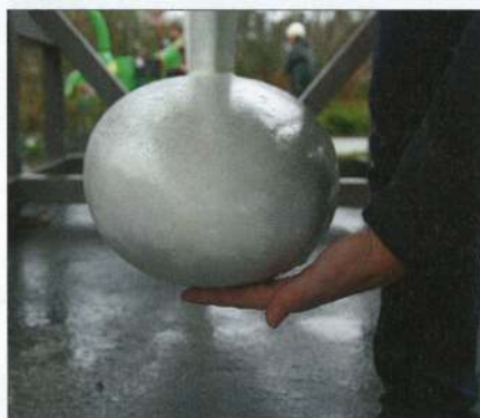
▲ Glissez la main sous le lest pour détecter d'éventuels signes de talonnage.
