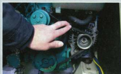
▲ Vérifiez la tension de la courroie et traquez les traces d'usure ou de rupture.
