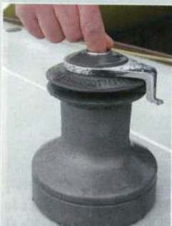
◀ Tourner l'axe central dans les deux sens pour vérifier que les winches ne sont pas grippés.
