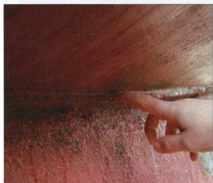
▲ Il faut vérifier que le joint d'étanchéité quille-coque ne se décolle pas.
