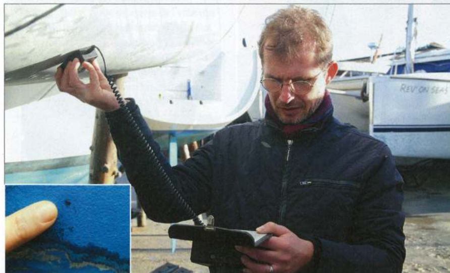
▲ Sébastien Viant regarde le taux d'humidité pour déterminer la porosité des premières couches de cette coque et pour voir si elle est atteinte d'osmose (petites bulles noires nauséabondes).
