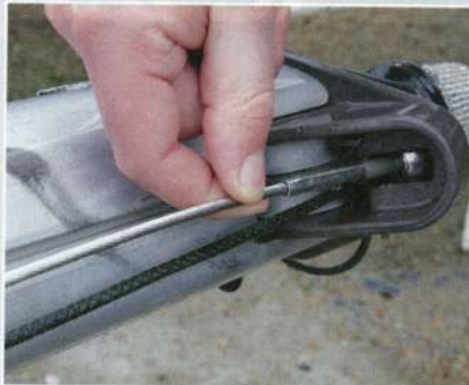
▲ Observer l'état des réas, du montage de l'étai en tête de mât.
