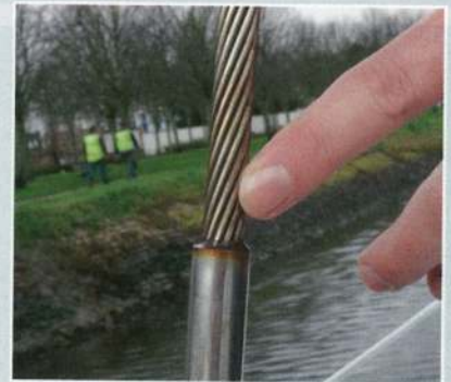
▲ Contrôlez le sertissage des haubans et ce qui se trouve sous les caches.
