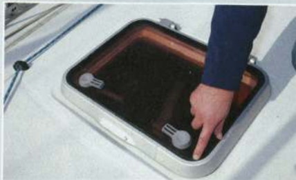
▲ Inspecter tous les hublots pour voir s'ils sont étanches ou fragilisés par le faïençage.
