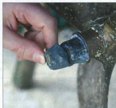
▲ Chaque anode corrodée est une anode à changer et une addition un peu plus salée.
