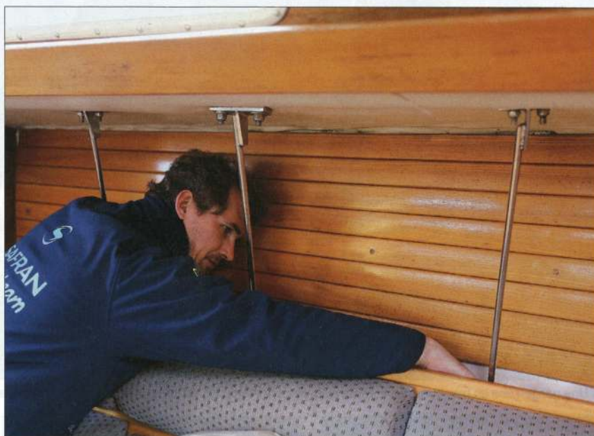
▲ Si un faïençage du gel-coat a été observé au niveau des cadènes, il faut jeter un œil attentif aux tirants de cadènes. Dans tous les cas, leur examen est indispensable.
