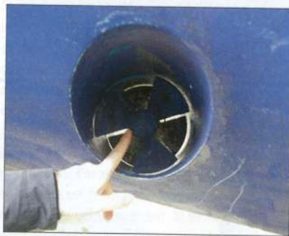
▲ Testez le propulseur d'étrave à flot ou vérifiez son état et celui de son anode à sec.
