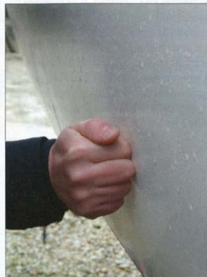
▲ Au son, notre expert parvient à savoir si la coque est délamée.
