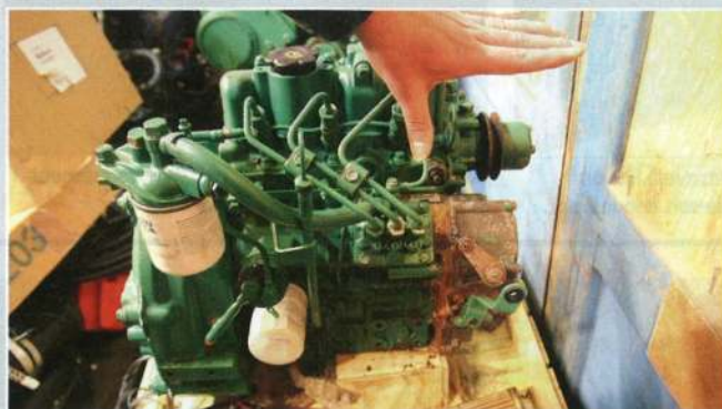
◀ Au fil des années, les légères infiltrations au niveau de la descente ont corrodé une partie de ce moteur.
