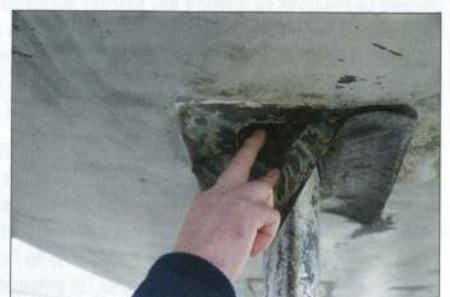
▲ Il y a peut-être un peu trop de jour entre le joint du sail-drive et la coque.
