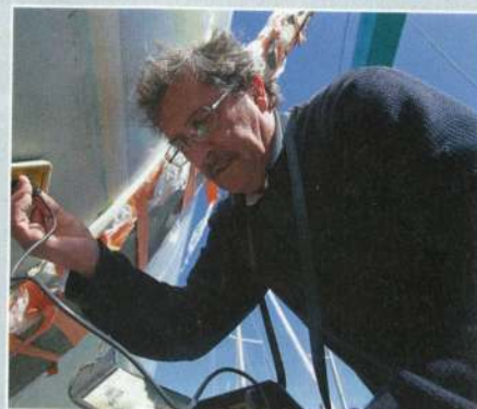
▲ L'examen des œuvres vives et du taux d'humidité est indispensable avant de signer.
