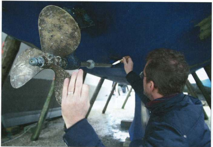
▲ Notre expert a une technique bien à lui pour vérifier si l'arbre n'est pas flambé. Il pose la pointe d'un couteau (ou sa clef de voiture) à l'entrée de l'étambot et tourne l'hélice pour voir s'il y a du jour.
