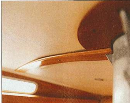
▲ Une courbure suspecte du rouf peut vous inciter à examiner la symétrie du pont.
