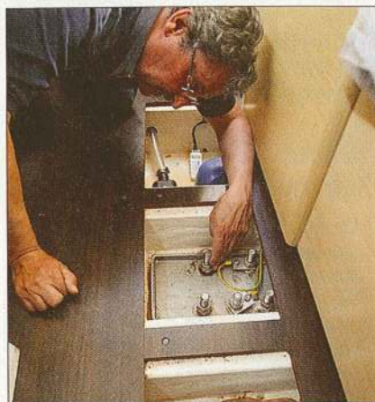
▲ L'état des boulons de quille est crucial. En cas de corrosion importante, il faut en savoir plus.
