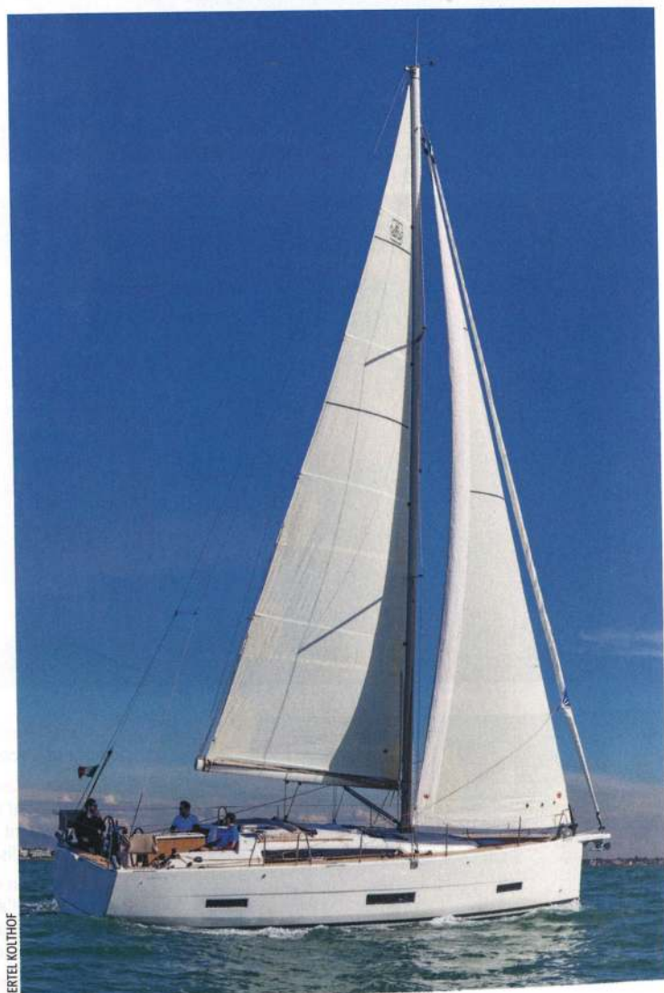
Grément 8/9°. Le génois présente peu de recouvrement en raison du haubannage fixé sur le livet, mais c'est déjà beaucoup mieux que le foc autovireur de série.
