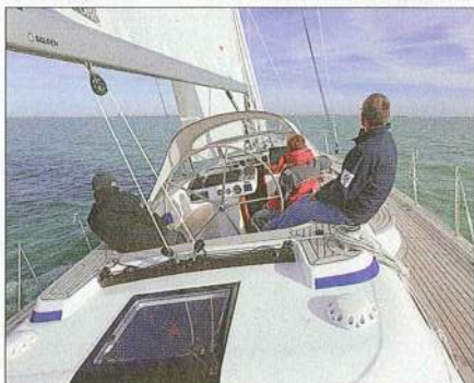
▲ Le chariot de la barre d'écoute de la grand-voile se règle depuis le poste de barre.
